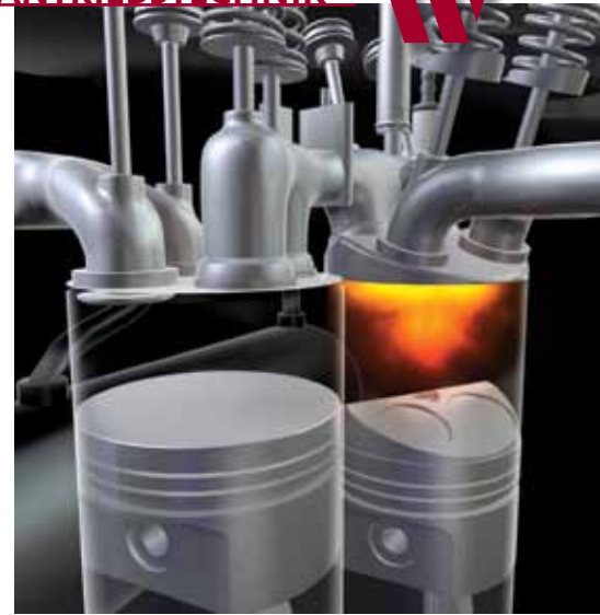
Darstellung der Zündung nach dem oberen Totpunkt.
