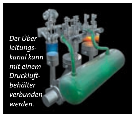
Der Verdichtungstakt ist vom Arbeitstakt abgetrennt.
