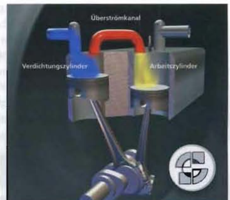
Ein Zylinderpaar absolviert alle vier Takte in einer Kurbelwellenumdrehung
